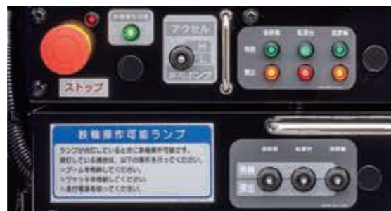
張出・格納操作部（転車台・鉄輪）
